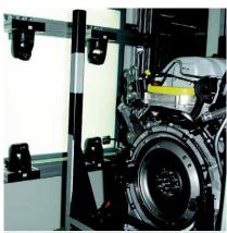
Kontrolle von KFZ-Motoren mit mehreren Kameras und Spezialbeleuchtung
