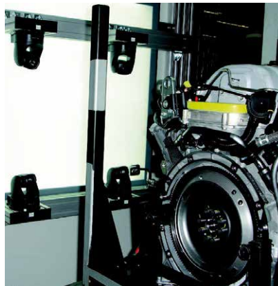
Kontrolle von KFZ-Motoren mit mehreren Kameras und Spezialbeleuchtung
