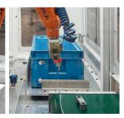
Nach erfolgter Freigabe greift der Roboter auf Basis der übermittelten Daten das Bauteil vom Förderband und beginnt mit der Bearbeitung.
